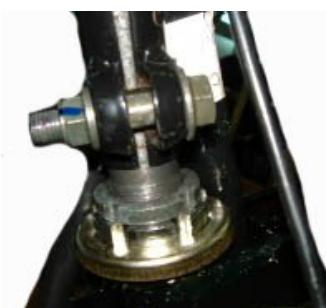
Ослабьте гайку крепления руля и снимите руль.
