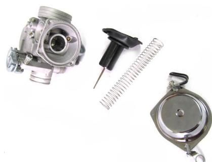
Отворачиваем винт-пробку главной дозирующей иглы и вынимаем иглу из золотника.
