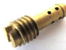
**ВНИМАНИЕ:** Не допускается использовать при очистке жиклёров инструменты с твёрдостью выше твёрдости материала жиклёров.
