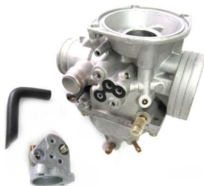
Отворачиваем винты крепления крышки поплавковой камеры карбюратора и снимаем крышку. Аккуратно снимаем резиновую уплотнительную прокладку.
