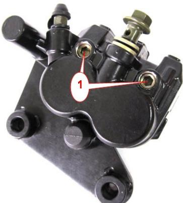
Выверните две пробки направляющих тормозных колодок (1)
