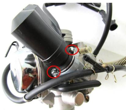
Вначале снимаем пусковой обогатитель для предотвращения повреждения пластикового корпуса. Для снятия отворачиваем два винта и вынимаем обогатитель.
